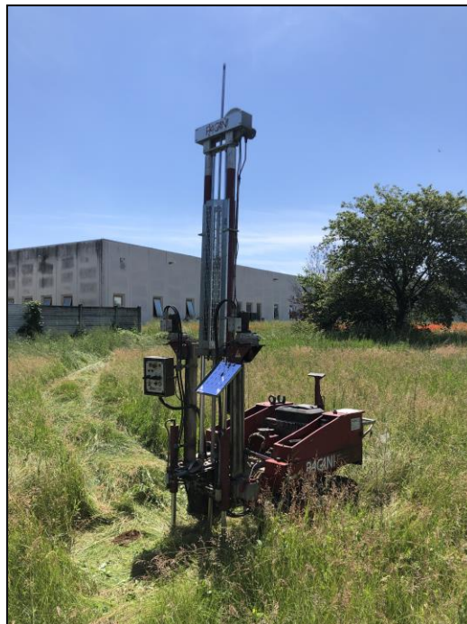
Figura 28- Penetrometro PAGANI – Postazione prova SCPT1 –
