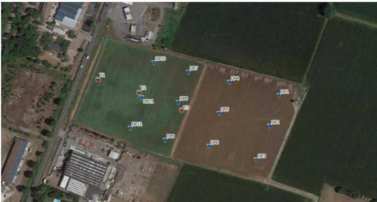
Figura 42: Ubicazione prove penetrometriche dinamiche (DP1-12) e trincee esplorative (T1-3) su ortofoto
