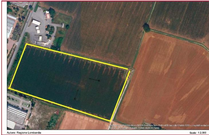
Ortofoto 2015 - Sono ben riconoscibili due tracce rettilinee e perpendicolari indicate dalle frecce nere che potrebbero indicare della discontinuità nel sottosuolo
