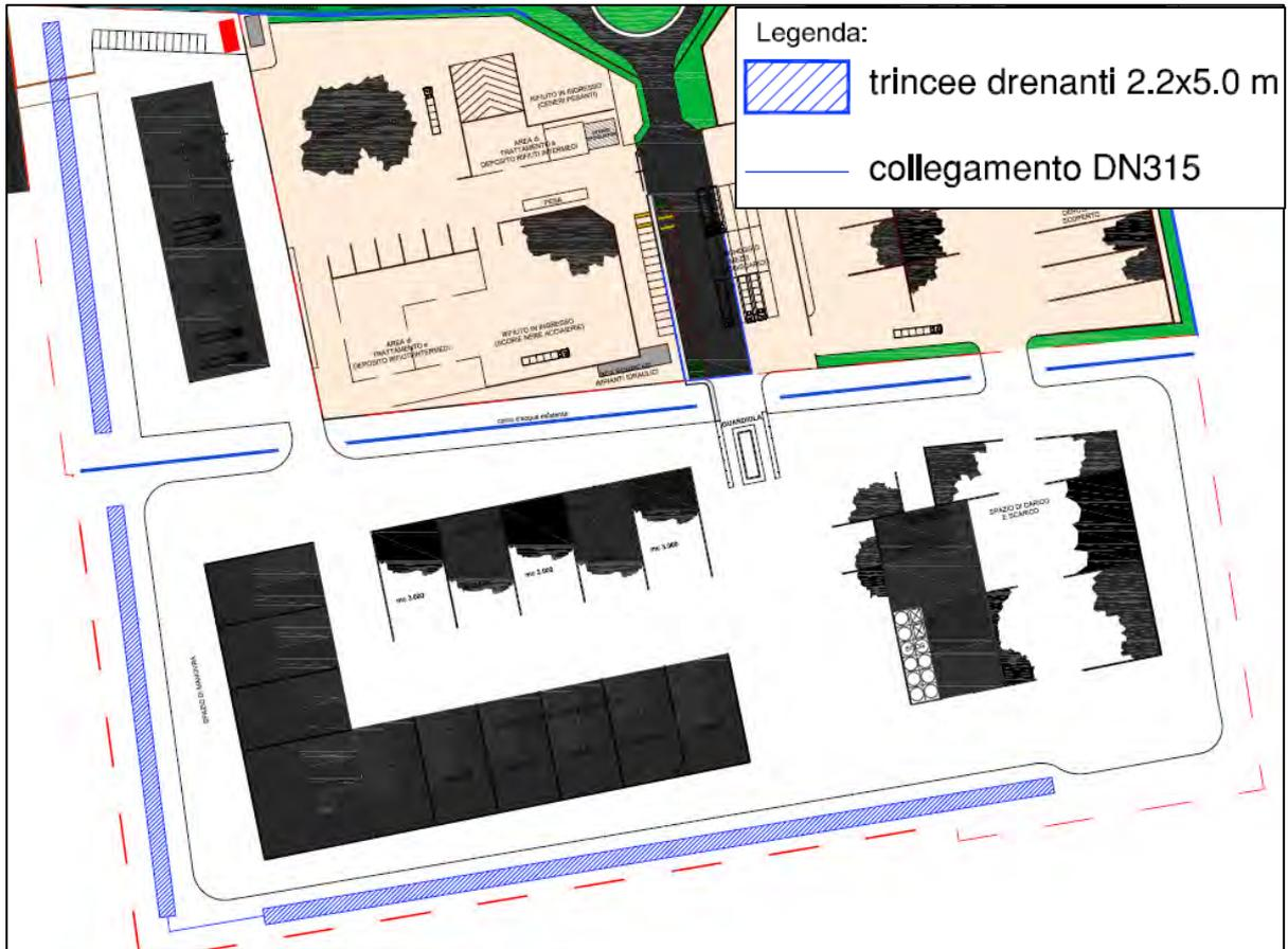
Figura 9 Planimetria di progetto - invarianza idraulica
