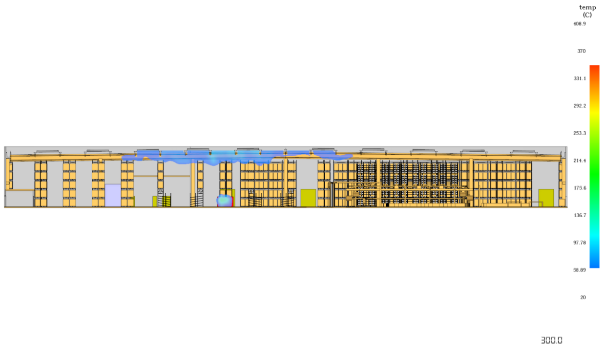
Figura 8 - Scenario S1: distribuzione dei valori di temperatura in sezione X = 278 m, al tempo t = 300 s
