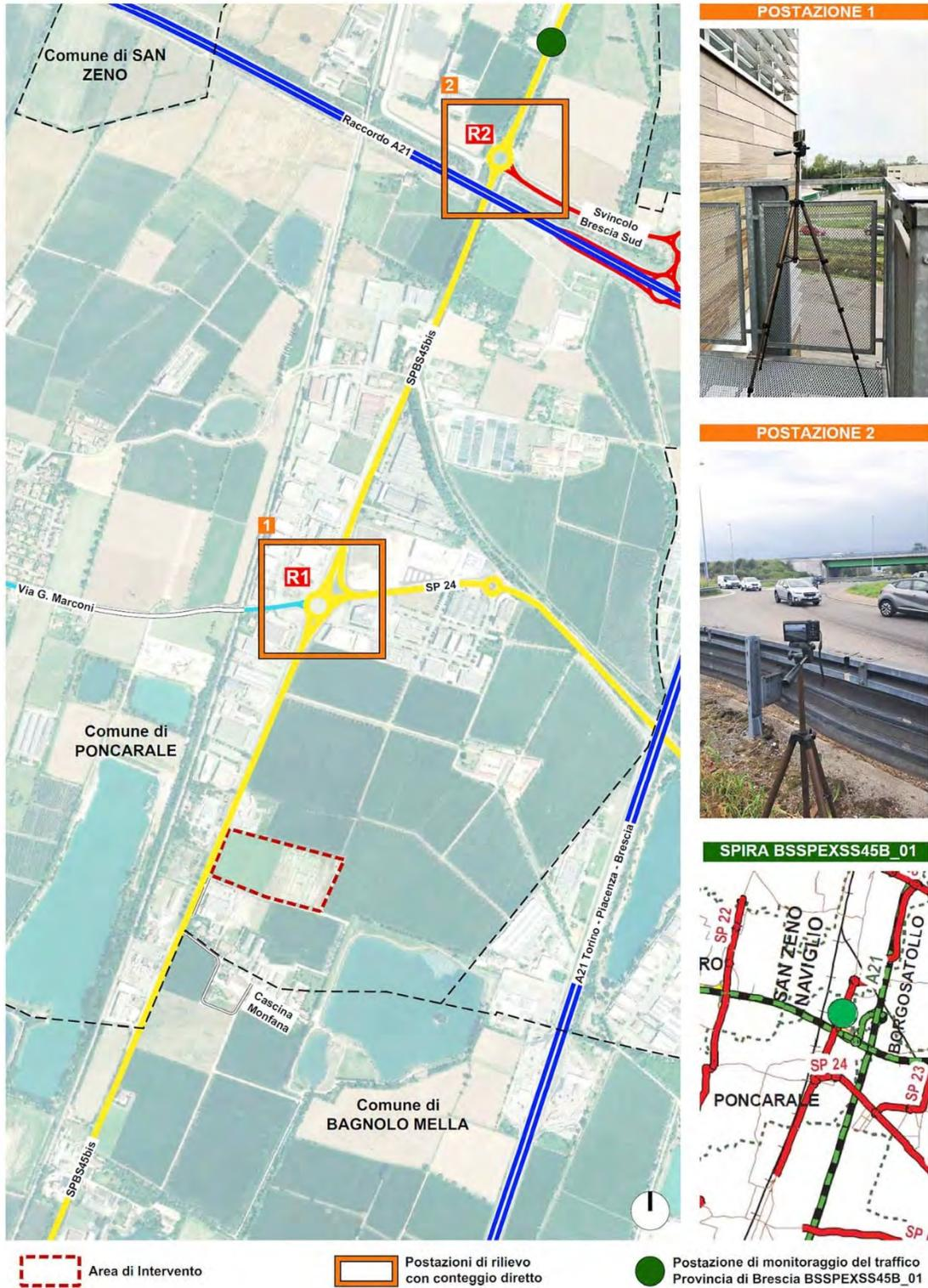
Figura 8 – Postazioni di rilievo e monitoraggio dei flussi di traffico
