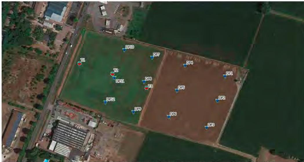
Figura 35: Ubicazione prove penetrometriche dinamiche (DP1-12) e trincee esplorative (T1-3) su ortofoto
